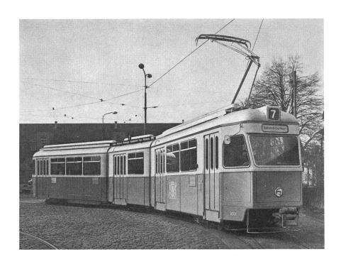
Einer der 126 Gelenktriebwagen der Verkehrsbetriebe der Stadt Zürich, für die Sécheron die elektronischen Steuerausrüstungen und die Mehrleiterkupplungen zu den automatischen GF-Kupplungen geliefert hat.
