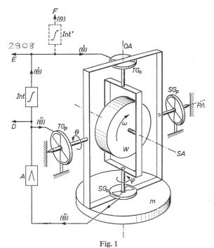
Prinzipielle Ausführung eines Trägheitsnavigationsgerätes, das aus einer Kombination eines Pendels mit einem Gyroskop besteht
