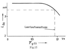
Sättigungsabhängigkeit der Kurzschlussinduktivität (als Mittelwert für 5. und 7. Harmonische gefunden) bei Stromrichterspeisung  $L_{\sigma \rm K}$  Kurzschlussinduktivität;  $\Psi_{\rm g(1)}$  Scheitelwert des verketteten Grundwellenflusses, bedingt durch Spannungsgrundschwingung
