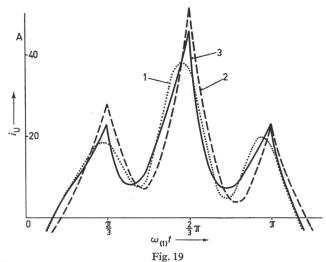
Nach den angegebenen Berechnungsverfahren ermittelter zeitlicher Stromverlauf bei einer Speisefrequenz von  $f_{(1)}=8~{\rm Hz}$  und Leerlauf  $[f_{2(1)}=0~{\rm Hz}]$
