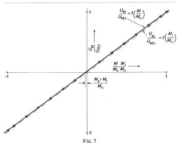
Experimentelle Überprüfung der Meßschaltung (Fig. 6) bei  $f_{(1)} = 40$  Hz,  $\Psi_{g(1)} = \Psi_{gon} = \text{konst.}$
