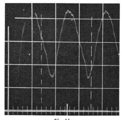
Fig. 11 Winkelgeschwindigkeit der ungekuppelten Maschine bei Stromrichterspeisung mit  $f_{(1)}=2$ ,18 Hz,  $I_{0\ {
