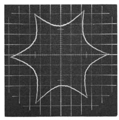
Fig. 18 Stromvektorortskurve bei offenen Schleifringen  $f_{(1)}=$  40 Hz,  $\psi_{(1)}=\psi_{\mathrm{gon}}$
