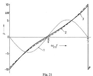
Nach den angegebenen Berechnungsverfahren ermittelter zeitlicher Verlauf der Dreiphasenleistung bei einer Speisefrequenz von  $f_{(1)}=40~{\rm Hz}$  und Leerlauf  $[f_{2(1)}=0~{\rm Hz}]$
