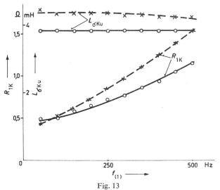
Frequenzabhängigkeit der Kurzschlussinduktivität und der Wirkkomponente der Kurzschlussimpedanz
