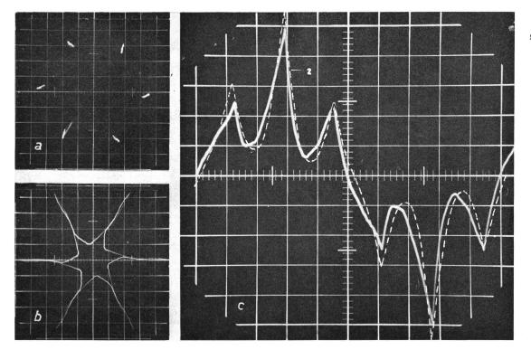
Oszillogramme bei einer Speisefrequenz  $f_{(1)} = 8$  Hz, Leerlauf  $(f_{2(1)} = 0$  Hz) a Spannungsvektorortskurve; b Stromyektorortskurve:
