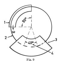
Messwerk zur Erfassung des zeitlichen Drehzahlverlaufes
