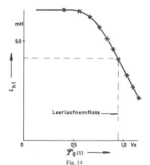
Sättigungsabhängigkeit der Hauptfeldinduktivität bei sinusförmiger Speisung  $L_{\rm h1}$  Hauptfeldinduktivität;  $\Psi_{\rm g(1)}$  Scheitelwert des verketteten Grundwellenflusses
