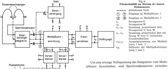
Die Drehmomentmessung nach Gl. (4b) setzt also die Erzeugung stromproportionaler Spannungen (siehe 2.1) und Grundwellenfluss-proportionaler Spannungen (siehe 2.2) voraus. Zur Produktbildung sind zwei Multiplikatoren erforderlich, deren Ausgangsspannungen voneinander (möglichst elektrisch) zu subtrahieren sind.
