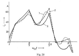
Nach den angegebenen Berechnungsverfahren ermittelter zeitlicher Stromverlauf bei einer Speisefrequenz von  $f_{(1)}=40~\mathrm{Hz}$  und Motorbetrieb  $(f_{2(1)}=+2~\mathrm{Hz}\approx f_{2n},~\omega_{(1)}t_{\mathrm{B}}=\pi/10~\mathrm{für}$  Verfahren 1 und 2; Leerlaufspannungsform im Verfahren 3 zugrundegelegt)
