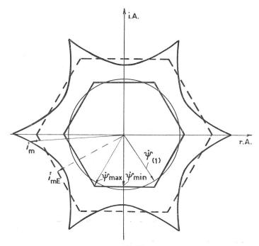
Fig. 16 Fluss- und Stromvektorortskurve bei offenen Schleifringen
