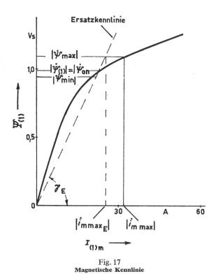
$\Psi_{(1)}$  Scheitelwert des verketteten Flusses bei sinusförmiger Speisung;  $I_{(1)\mathrm{m}}$  Scheitelwert des Magnetisierungsstromes bei sinusförmiger Speisung;  $\psi_{\mathrm{on}}$  Leerlauf-Nennflussvektor Weitere Bezeichnungen siehe Fig. 16
