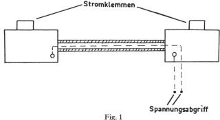
Shunt zur oszillographischen Aufnahme des Stromverlaufes
