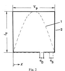
Sinusmesswindung zur Erfassung der Grundwellenfelder I Sinuswindung; 2 Durchmesserwindung;  $\tau_{\rm D}$  Polteilung;  $l_{\rm a}$  Ankerlänge; X Ortsvariable;  $u_{\rm D}$  Meßspannung der Durchmesserwindung;  $u_{\rm S}$  Messspannung der Sinuswindung
