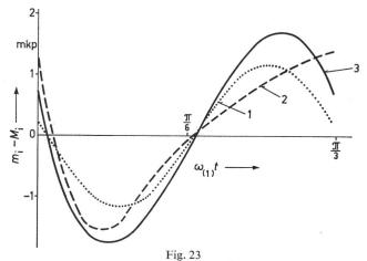
Nach den angegebenen Berechnungsverfahren ermittelter zeitlicher Verlauf des inneren Pendelmoments bei einer Speisefrequenz von  $f_{(1)}=40~\mathrm{Hz}$  und Motorbetrieb [ $f_{2(1)}=+2~\mathrm{Hz},~M_{\mathrm{i}}=12,7~\mathrm{mkp};~\omega_{(1)}t_{\mathrm{B}}=\pi/10~\mathrm{für}$  Verfahren 1 und 2; Leerlaufspannungsform im Verfahren 3 zugrundegelegt]
