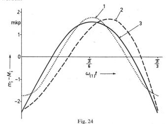
Nach den angegebenen Berechnungsverfahren ermittelter zeitlicher Verlauf des inneren Pendelmoments bei einer Speisefrequenz von  $f_{(1)}=8~{\rm Hz}$  und Generatorbetrieb  $[f_{2(1)}=-2~{\rm Hz}]$
