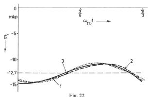
Nach den angegebenen Berechnungsverfahren ermittelter zeitlicher Verlauf des inneren Drehmoments bei einer Speisefrequenz von  $f_{(1)}=40\,$  Hz und Generatorbetrieb  $[f_{2(1)}=-2\,$  Hz]
