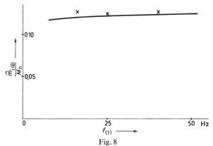
Vergleich von errechneten und gemessenen Pendelmomenten (Leerlauf,  $\Psi_{g(1)} = \Psi_{gon} = \text{konst.})$  — errechnet;  $\times$  gemessen
