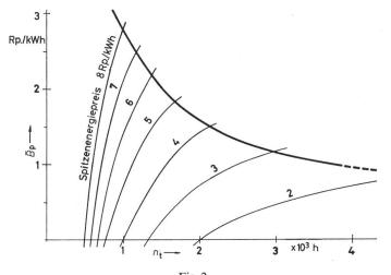
Fig. 2 Einkaufspreis der Pumpenergie
