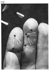
Streichholzkopf ähnlich und sind gegenüber mechanischen Einwirkungen sehr widerstandsfähig. Sie bestehen aus einem Kovarplättchen, das zusammen mit den Anschlüssen den tragenden Rahmen bildet, dem aufgebrachten Siliziumsystem, das mit den Anschlüssen durch Goldbondierung verbunden ist, und der Epoxymasse, in die das fertig montierte Bauelement getaucht ist. Mit den bandförmigen Anschlüssen lassen sich gute Lötverbindungen herstellen.
