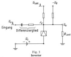
$-U_{\rm B}$ Gleichspannungsquelle;  $U_{\rm a}$  Ausgangsspannung;  $U_{\rm c}$ Gleichspannungsquelle;  $U_{\rm e}$  Eingangsspannung;  $B_{\rm Last}$  Lastwiderstand;  $U_{\rm takt}$  Taktspannung
