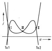
Fig. 7 Kennliniendiagramm des Tunneldiodenpaars bei Abwesenheit eines Eingangsimpulses
