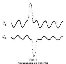
Spannungen an inverter  $U_{\rm a}$  Ausgangsspannung;  $U_{\rm e}$  Eingangsspannung
