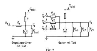
Anwendung der bistabilen Schaltung R Vorwiderstand im Taktkreis;  $R_{\rm a1}$ ,  $R_{\rm a2}$ ,  $R_{\rm a3}$  Lastwiderstände;  $R_{\rm e}$  Vorwiderstand im Eingangskreis;  $R_{\rm e1}$ ,  $R_{\rm e2}$ ,  $R_{\rm e3}$  Vorwiderstände in den Eingangskreisen;  $R_{\rm Last}$  Lastwiderstand;  $U_{\rm a}$  Ausgangsspannung;  $U_{\rm e}$  Signalspannung am Eingang;  $U_{\rm e1}$ ,  $U_{\rm e2}$ ,  $U_{\rm e3}$  Eingangsspannungen;  $U_{\rm takt}$  Taktspannung
