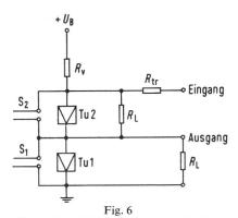
Prinzipschaltbild des Tunneldiodenflipflops mit Verzögerungsleitungen  $U_{\rm B}$  Gleichspannungsquelle;  $R_{\rm v}$  Vorwiderstand;  $R_{\rm tr}$  Entkoppelungswiderstand im Eingangskreis;  $R_{\rm L}$  Lastwiderstand;  $S_1$ ,  $S_2$  Verzögerungsleitung; Tu 1, Tu 2 Tunneldioden
