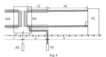
Hochspannungsanlage mit Anlagen- und Sondererdung
