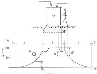
${\rm Fig.~1} \\ {\rm Erdungsspannung}~U_e~{\rm in~Abh\"{a}ngigkeit~des~Abstandes~}x~{\rm von~einer} \\ {\rm Hochspannungsanlage~}HA \\$
