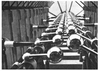
Fig. 6 Ansicht der 16 Schaltfunkenstrecken von unten
