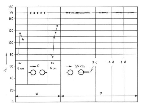
Fig. 8 Streuung der Ansprechspannung der Schaltfunkenstrecken nach dem Umbau
