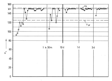
der Boden- und Dachlucken etwas staubhaltige Luft aus dem Laderaum nach oben in die Schlagweite der Schaltfunkenstrecken gelangt. Es treten dadurch sofort Fehlansprechungen auf. Die Streuung der Ansprechspannung der 16 parallelen Schaltfunkenstrecken ist ein Mass für die Reinheit der Luft im Schutzraum.
