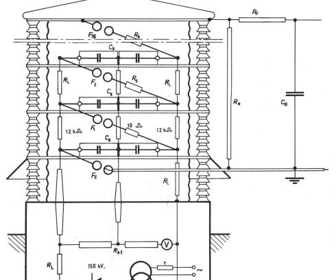
Fig. 3 Schematische Darstellung des Freiluft-Stossgenerators von 2,4 MV
