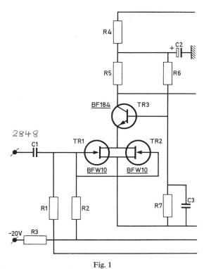
Eingangsstufe eines Bildsignalverstärkers mit Feldeffekttransistoren
