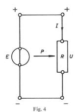
Schema eines einfachen Stromkreises
