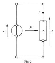
Schema eines einfachen Stromkreises
