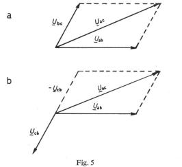
Zusammensetzung der Spannungen, die zwischen drei Punkten a, b und c von verschiedenem Potential bestehen
