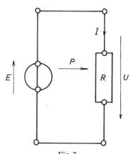
Fig. 2 Schema eines einfachen Stromkreises
