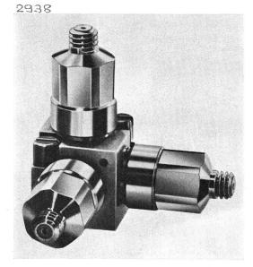
höchsten Beschleunigungen. Dank der hohen Eigenfrequenz von 60 kHz zeigt es bis 12 kHz nur 5 % Abweichung. Wie bei allen Quarz-Accelerometern ist die untere Grenzfrequenz sehr tief, so dass auch lang andauernde Stösse gemessen werden können.
