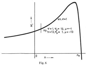
Asynchrones Grundwellen-Drehmoment (as) und bei  $n_{\rm sy} = \frac{1}{7} n_{\rm g}$  auftretende synchrone Drehmomente (sy)
