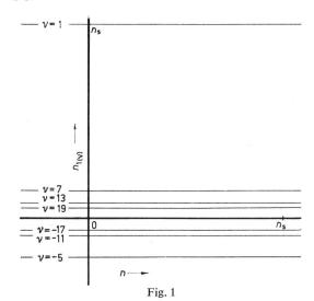
Drehzahlen  $n_{1(v)} = f(n)$  der von einem dreiphasigen Stator erzeugten Drehwellen nach Gl. (1)
