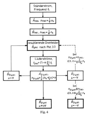
Entstehen und Überlagerung der von den Wicklungen erzeugten Drehwellen
