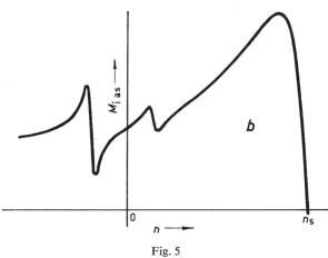
Asynchrones Drehmoment als Funktion der Drehzahl (Schleifringrotor,  $m_1=m_2=3$ ; schematisch) a Teildrehmomente  $M_{\mathbf{i}}$   $_{(9)}$   $_{38}=f(n)$  b asynchrones Drehmoment  $M_{\mathbf{i}}$   $_{38}=f(n)$  n Rotordrehzahl;  $n_8$  synchrone Drehzahl
