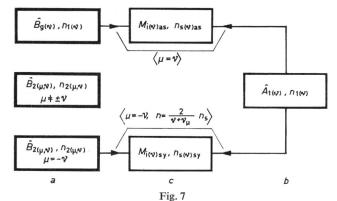
Schema der zeitlich konstanten, auf den Stator wirkenden elektrodynamischen Drehmomente
