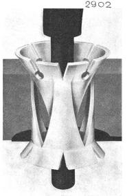
nungen» sauber auf der oberen Kupferkaschierung verfliesst. Die Hauptvorteile der «Griplet-Durchkontaktierung» bestehen in der visuell kontrollierbaren Durchlöt-Qualität, der — im Vergleich zu galvanischen Methoden — wesentlich dickeren Metallquerschnitte in den Bohrungen, der grösseren mechanischen Festigkeit und der sicheren Fixierung aller Bauteile während des Tauchlötens, ohne jede Verformung der Drahtenden.
