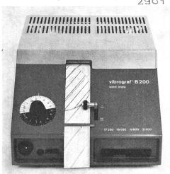
volltransistorisiert; seine austauschbaren Schaltungen verleihen ihm praktisch unbegrenzte Anwendungsmöglichkeiten. In der Tat erlauben es diese Schaltungen, unmittelbar von der Kontrolle eines Uhrwerktyps zu der eines anderen überzugehen (mechanische, elektromechanische Uhrwerke, Uhrwerke mit hoher Frequenz oder Stimmgabel). Diese neue Technik bietet auch die Möglichkeit, das Gerät an jedes zukünftige Uhrwerk anzupassen, das sich durchsetzen wird.
