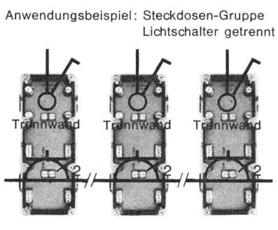
Der WEIDMANN-Einlasskasten H 137 ermöglicht jetzt den rationellen Anschluss 2 getrennter Drehstrom-Stromkreise in einen Einlasskasten. Die wahlweise einsetzbaren Trennwände und die vielen Anschlussmöglichkeiten erlauben die verschiedensten Varianten zur Trennung der Stromkreise. Ein weiterer Vorteil für eine schnelle und saubere Montage sind die im Kunststoffgehäuse eingelassenen Metallgewindebuchsen zur Aufnahme sämtlicher normierter Befestigungsplatten.
