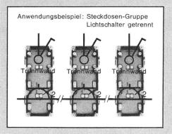
Der WEIDMANN-Einlasskasten H 137 ermöglicht jetzt den rationellen Anschluss 2 getrennter Drehstrom-Stromkreise in einen Einlasskasten. Die wahlweise einsetzbaren Trennwände und die vielen Anschlussmöglichkeiten erlauben die verschiedensten Varianten zur Trennung der Stromkreise. Ein weiterer Vorteil für eine schnelle und saubere Montage sind die im Kunststoffgehäuse eingelassenen Metallgewindebuchsen zur Aufnahme sämtlicher normierter Befestigungsplatten.
