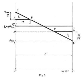
Diagramm der klassierten Belastungen (Dauerkennlinie) mit teilweiser Kompensierung durch ein Pumpspeicherwerk
