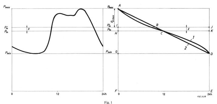
Tägliches Belastungsdiagramm des untersuchten Netzes
