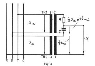
Schaltung zur Messung der relativen Gegenspannung  $U_{\rm SR},~U_{\rm TS}$  Dreieckspannungen;  $U_0''$  Gegensystem der Sternspannungen
