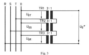
Schaltung zur Messung der relativen Nullspannung  $U_{0\mathrm{T}},\,U_{0\mathrm{S}},\,U_{0\mathrm{R}}$  Sternspannungen;  $U_0{}^{\prime\prime\prime}$  Nullsystem der Sternspannungen
