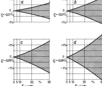
Fehler in Abhängigkeit von  $K_{\rm us}$  an der Meßstelle 1 a zur Zeit der absolut kleinsten Spannungsunsymmetrie; b zur Zeit einer mittleren Spannungsunsymmetrie während der gesamten Messzeit; c zur Zeit einer mittleren Spannungsunsymmetrie während der Arbeitszeit; d zur Zeit der absolut grössten Spannungsunsymmetrie  $F_{\Delta}$  Fehler bei symmetrischer Belastung;  $K_{\rm us}$  Unsymmetriegrad der Belastung
