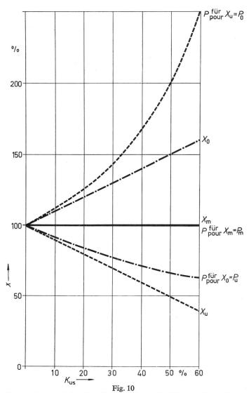
Zusammenhang zwischen dem Unsymmetriegrad der Belastung  $K_{\rm us}$  und den Belastungsreaktanzen  $X_{\rm u}$ ,  $X_{\rm m}$  und  $X_0$  mit den zugehörigen Belastungen  $P_0$ ,  $P_{\rm m}$  und  $P_{\rm u}$
