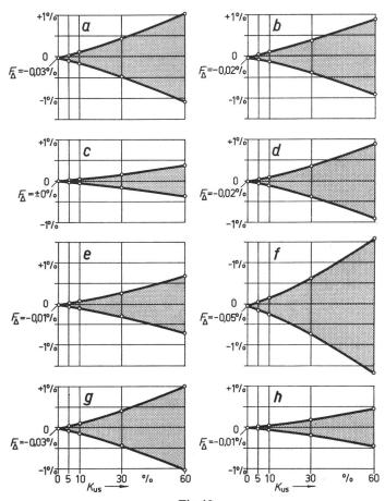
Fig. 13 Fehler in Abhängigkeit von  $K_{\mathrm{US}}$  an den Meßstellen 3 bis 10 zur Zeit der absolut grössten Spannungsunsymmetrie Erläuterungen siehe im Text
