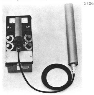
nendetektoren, Szintillationszähler oder Geiger-Müller-Zählrohre. Das Impulsfrequenzmeter hat 9 lineare Messbereiche und drei einstellbare Zeitkonstanten. Durch einen Einschub kann das Gerät mit einem Zähler oder Alarmkreis ergänzt werden.
