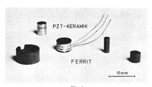
Fig. 1 Grössenvergleich eines piezoelektrischen und piezomagnetischen Keramikwandlers für  $t_0=455~\mathrm{kHz}$
