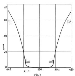
Vorschlag einer Selektionskurve für AM-Rundfunkempfänger, die mit mechanischen Filtern entsprechend Fig. 3 realisiert worden ist a Dämpfung; f Frequenz
