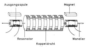
Fig. 9 Mechanisches Filter mit longitudinal gekoppelten Kreisplattenbiegern und piezomagnetischer Anregung
