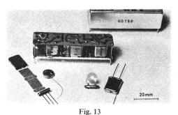
Quarzfilter in Brückenschaltung mit Einzelteilen Einzelheiten siehe im Text
