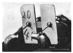
Fig. 15 Mechanisches Zweikreis-Quarzfilter mit Flächenscherschwingern
