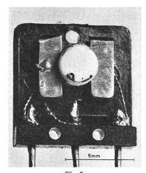
Fig. 5 Mechanisches Zweikreisfilter in H-Form
