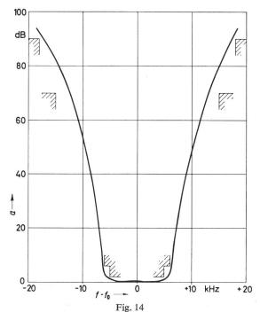
Selektionskurve eines Quarzfilters für UKW-FM-Funksprechgeräte bei 20 kHz Kanalraster
