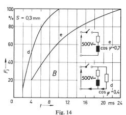
Summenhäufigkeit der Lichtbogen-Brenndauer von Wechselstrom-Lichtbögen bei Verwendung der angegebenen Prüfstromkreise
