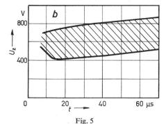
Die Wiederverfestigung der Schaltstrecke nach dem Abschalten von Wechselstrom 75 A, 690 V,  $\cos\varphi=0.4$  [8; 11]
