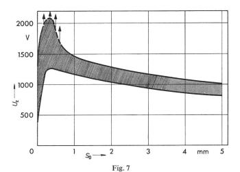
Bereich gemessener Wiederzündspannungen  $U_Z$  in Abhängigkeit vom Kontaktabstand  $S_0$  [9]
