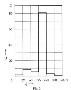
Die Häufigkeitsverteilung  $-f_j$  der Nennspannung  $U_n$  von Schützenspulen Durchschnittswerte
