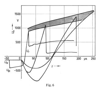
Wiederzündspannungen als Funktion der Zeit nach dem Stromnulldurchgang bei Einfachunterbrechung [9]
