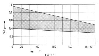
Streubereich der Leistungsfaktoren cos  $\varphi$  von Schützen bei abnormalen Betriebsbedingungen in Abhängigkeit vom thermischen Nennstrom  $I_{\rm th}$  der Schütze
