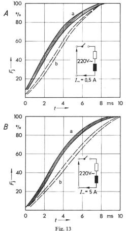
Summenhäufigkeit  $F_j$  der Lichtbogen-Brenndauer von Wechselstrom-Lichtbögen bei simulierten, abnormalen Betriebsbedingungen (Störungsfall) Spannung: 220 V; Strom I=0,5 A (A) und 5 A (B);  $\cos\varphi=0,4$  bis 0,7; Kontaktöffnung: a=0,25; b=2,5 mm; Einfachunterbrechung; Kontaktmaterial: Feinsilber; Kontakt-Durchmesser =5,5 mm; Öffnungs-Geschwindigkeit: 0,2 m/s; Anzahl der Schaltungen pro Parameter-Paarung: 200 t Lichtbogen-Brenndauer
