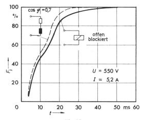
Fig. 15 Summenhäufigkeit  $F_{\rm j}$  der Lichtbogen-Brenndauer von Wechselstrom-Licht-
