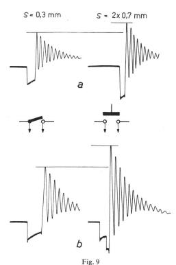
Wiederkehrende Spannung beim Abschalten des Prüfstromkreises für abnormale Betriebsbedingungen an Steuerschaltern mit Einfach- und Doppelunterbrechung
