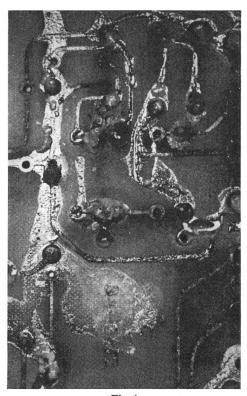
Fig. 4 Korrosionserscheinungen durch Salzsäure an einer gedruckten Schaltplatte Das hygroskopische Kupferchlorid verläuft und bildet Nebenpfade für den Strom
