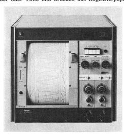
Die Schreibgeschwindigkeit ist bis zu 40mal höher als diejenige anderer Schreiber. Diese Schreiber werden bereits in einem weiten Bereich von Anwendungsgebieten, wo es auf erhöhte Zuverlässigkeit und Genauigkeit besonders ankommt, eingesetzt: z. B. in der biomedizinischen Forschung, in der Massenspektrometrie oder als Peripheriegeräte zu Computern.
