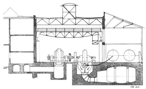
Verteilleitung und Unterwasserkanal erhalten die Francisturbinen *obenliegenden* Einlauf (Fig. 4). Dies gestattet unter anderem, die Maschinenachsen um 1,4 m tiefer zu legen, was mit Rücksicht auf die Kavitation sehr erwünscht ist. Wasserzulauf- und -ablaufrohre stören sich nicht mehr. Die Wasserführung darf nunmehr als völlig befriedigend bezeichnet werden. Auf Durchflusskompensatoren an den Francisturbinen konnte verzichtet werden.
