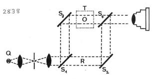
Fig. 1 Strahlengang eines Mach-Zehnder-Interferometers Bezeichnungen siehe im Text
