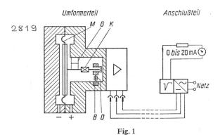
Messumformer für Differenzdruckmessung
