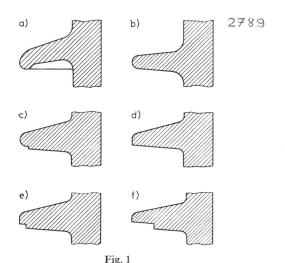
Schirmprofile für Abtropfversuche an Glasisolatoren a Normalprofil nach DIN 48115; b-f untersuchte Glasprofile; f günstige Abtropfform
