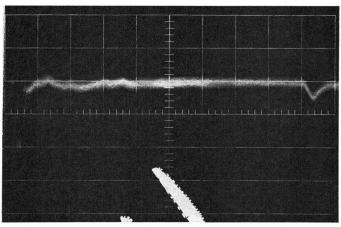
$\begin{array}{c} Fig.~20 \\ \textbf{Oszillogramm einer Welle im Erdmodus} \\ Maßstäbe:~2~\mu s/Teilung,~5~V/Teilung \end{array}$
