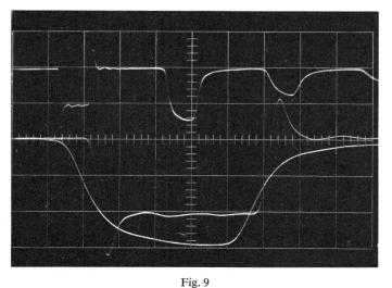
Oszillogramm einer Übertragung von Impulsen über ein Hochspannungskabel, dessen Ende offen ist
