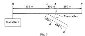
Schema eines einfachen Netzes zur anschaulichen Darstellung wie man den gestörten Ast feststellen kann
