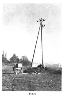
Messplatz für die Messungen an einer Freileitung
