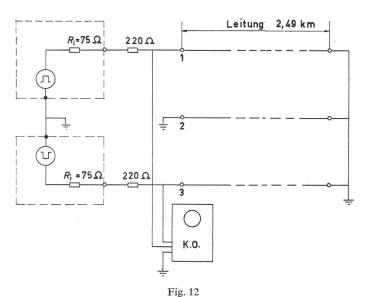
Schaltung für Messungen an einer Freileitung
