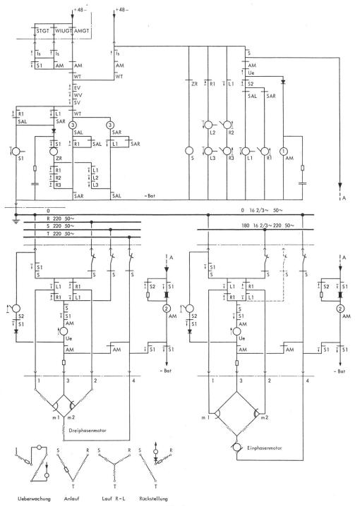
Fig. 1 Steuerschaltung eines Weichenantriebes
