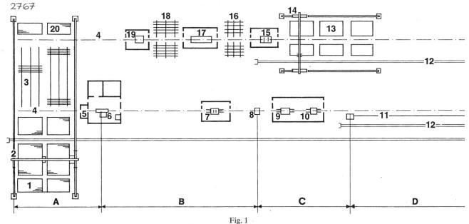
Plan einer nicht vollautomatischen Anlage zum Schweissen von Alt- und Neuschienen
