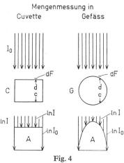
Mengenmessung in planparalleler Cüvette und zylindrischem Gefäss
