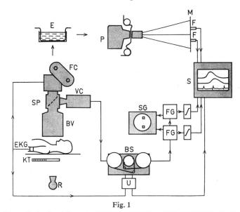
Schematische Darstellung des Prinzips der Röntgencinedensitometrie und der Röntgenvideodensitometrie
