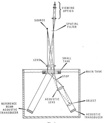
Fig. 6 Flüssigkeitsoberflächen-Holographie
