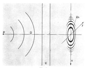
Fig. 2 Fresnelsche Zonenplatte
