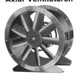
für hohe Drücke und Volumen, 300-1900 mm Ø. Flügel und Klemmplatten aus glasfaserverstärktem Polyester-Harz mit neuartiger, patentierter Winkeleinstellung.
