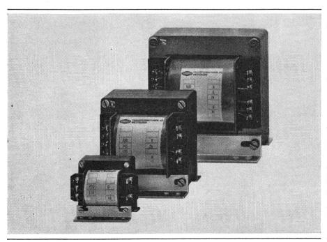
DIN-Einphasen-Transformatoren können als stehend oder liegend unverschalte Typen von 5 VA bis 4000 VA für die Verwendung in trockenen oder feuchten Räumen geliefert werden. Primär- und Sekundärwicklung sind getrennt. Die Anschlüsse sind auf Klemmen geführt oder es können bei den Typen bis 250 VA Lötösen angebracht werden. Alle Typen tragen das Qualitätszeichen des SEV Klasse 2b.
