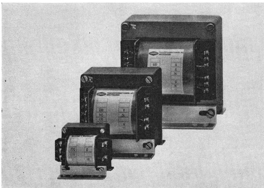
DIN-Einphasen-Transformatoren können als stehend oder liegend unverschalte Typen von 5 VA bis 4000 VA für die Verwendung in trockenen oder feuchten Räumen geliefert werden. Primär- und Sekundärwicklung sind getrennt. Die Anschlüsse sind auf Klemmen geführt oder es können bei den Typen bis 250 VA Lötösen angebracht werden. Alle Typen tragen das Qualitätszeichen des SEV Klasse 2b.
