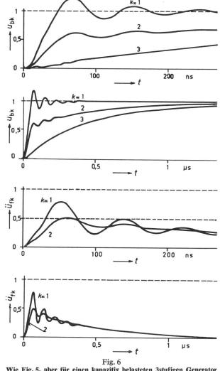
Wie Fig. 5, aber für einen kapazitiv belasteten 3stufigen Generator Belastungskapazität  $C_{\rm B}=88$  pF; Entladewiderstand  $R_{\rm e}=1,75$  k $\Omega$ ; t Zeit Weitere Bezeichnungen siehe Fig. 1
