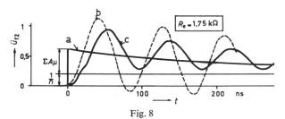
Das Rechteckstossverhalten (a) der Ersatzschaltung in Fig. 7, die nach Gl. (11) berechneten Überspannungen (b) und die oszillographierten Überspannungen (c) an der zweiten Schaltfunkenstrecke
