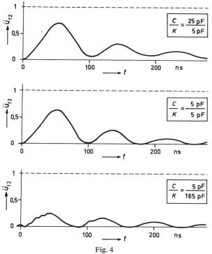
Überspannung  $\ddot{u}_{\rm f2}$  an der zweiten Schaltfunkenstrecke bei verschiedenen Verhältnissen von Erd- zu Längskapazität des 6stufigen leerlaufenden Generators
