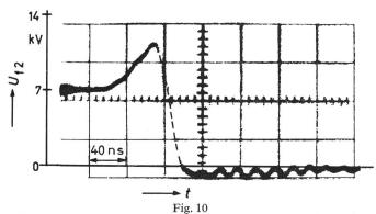
Die Spannung  $u_{\mathrm{f2}}$  an der zweiten Schaltfunkenstrecke nach Zündung der ersten Schaltfunkenstrecke bei einer Ladespannung von 7 kV Die zweite Schaltfunkenstrecke zündet in der Nähe des Scheitels der Überspannung
