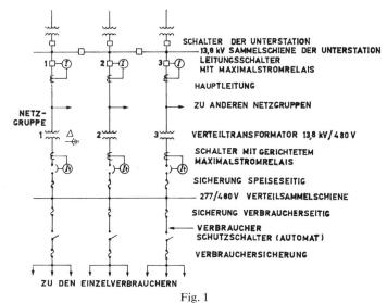
Typischer Aufbau eines Verteilnetzes
