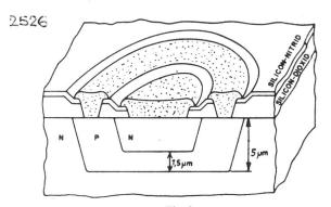
$\label{eq:Fig.2} \textbf{MIS-Transistor (planar epitaxial) im Querschnitt}$  Die punktierten Zonen stellen die Kontakte aus Pt $_5$ Si $_2$ -Ti-Pt-Au dar
