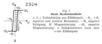
Kerns in seinen negativen Sättigungszustand bewirkt. Beim Übergang vom positiven in den negativen Zustand wird in beiden Wicklungen eine Spannungsspitze induziert, die mittels einer separaten Wicklung als Ausgangsinformation des Zählers verwertet werden kann.
