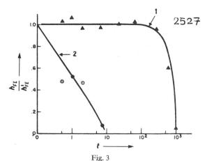
Künstliche Alterung von SiO2-passiviertem und MIS-Transistor
