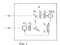
Schematischer Aufbau des Zweiweg-Nachrichtenverbindungssystems
