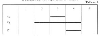
Sur cette figure, on remarque le caractère séquentiel du système puisqu'à un même état des variables d'entrée (phases 2 et  $4: x_1 x_2 = 01$ ) doivent correspondre des états différents des fonctions de sortie (phases 2: Z = 0, phase 4: Z = 1).
