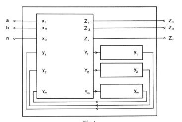
Représentation schématique d'un système logique séquentiel
