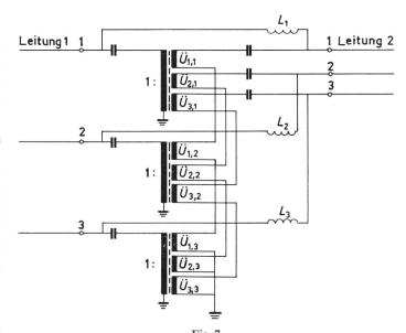
Schaltung zum reflexionsfreien Anpassen von zwei Leitungen mit unterschiedlichem Aufbau
