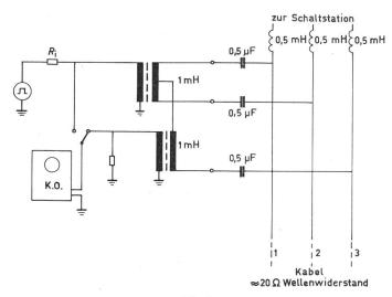
Fig. 1 Brückenschaltung, die nur Echos sichtbar werden lässt, bei denen das Spannungsverhältnis  $U_{1,2}:U_{2,3}$  gegenüber der ausgesendeten Welle verändert ist.  $R_{\rm i}$  Innenwiderstand des Impulsgenerators
