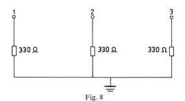
Abschlusswiderstände für eine Leitung nach Fig. 3, so dass für die Leitermodi keine Reflexionen entstehen
