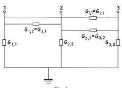
Fig. 4 Abschluss einer Leitung mit den Leitwerten  $G_{1,1}...G_{3,3}$  Die Figur bezieht sich auf die Gln. (24a)...(24c)
