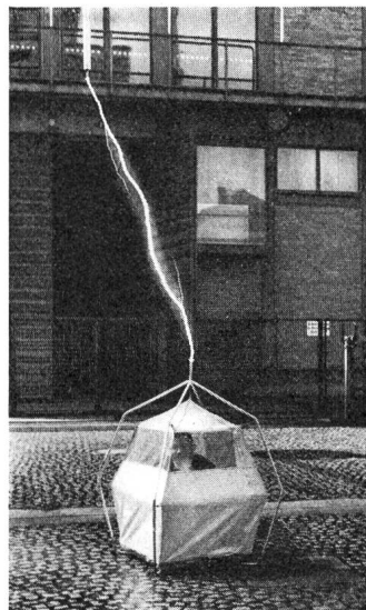
Fig. 3 Erprobung eines Blitzschutzzeltes unter Regen bei einer Stossspannung von 2 Millionen V
