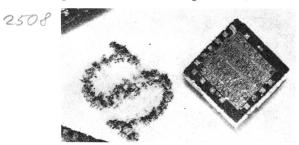
tionen übernehmen. Miniaturisierung bedeutet aber gleichzeitig höhere Zuverlässigkeit und Wirtschaftlichkeit. Auf dem Bild sind Systeme (Chips) integrierter Großschaltungen mit 380 MOS-Transistoren im Grössenvergleich zu schreibmaschinengeschriebenen Buchstaben dargestellt. (SGS-Fairchild, Stuttgart)
