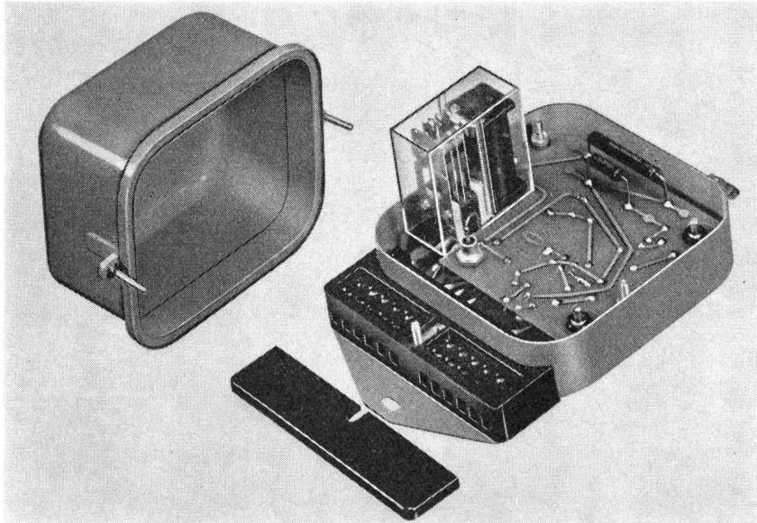
Transistorisierte Spannungs-Relais TSU
