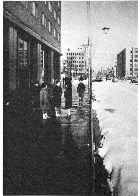
Fig. 29 Elektrische Strassenheizung in Sapporo Flächenleistung 20 W/m 2 , System Furukawa
