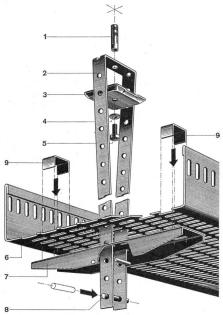
Neuartige, verstellbare, zentrale Decken-Aufhängung. Kein Einfädeln mehr. Die Kabel werden gestreckt eingelegt, da keine seitlichen, störenden Aufhängungen. Keine Spezialwerkzeuge nötig. Stark verkürzte Montagezeiten, auch mit ungelerntem Personal.
