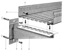
Decken- und Wandbefestigungen sind normalisiert. 5 HEER-Kanalbreiten: 140, 210, 280, 350 und 420 mm. Dazu passende Zubehörteile: Horizontale und vertikale Bogenstücke, T-Stücke. +-Stücke, Reduktions- und Abzweigstücke usw.
