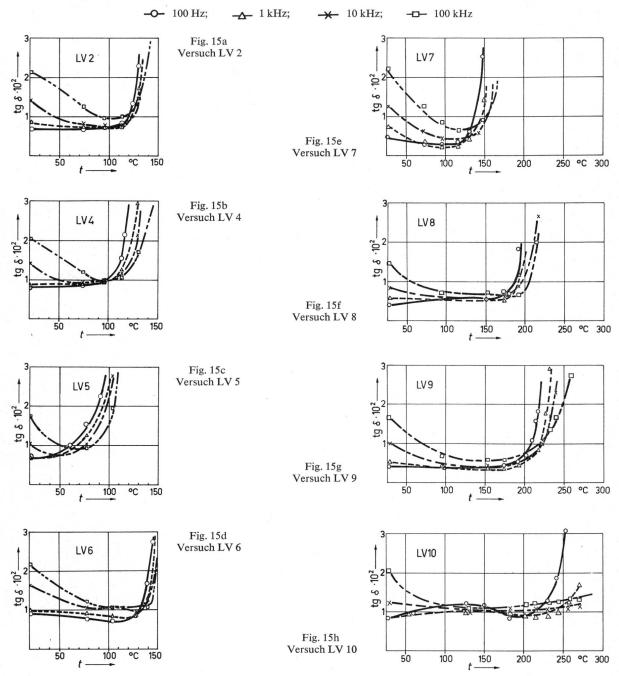
Dieser Wert wurde aus messtechnischen Gründen möglichst nahe der Netzfrequenz (50 Hz) gewählt, weil höhere Temperaturen an Wicklungen praktisch nur bei der Netzfrequenz auftreten. Wie später gezeigt wird, spielt die Messfrequenz im Bereich von 100 Hz...100 kHz bei den hier untersuchten Lackdrähten, mit einer Ausnahme, eine untergeordnete Rolle.
