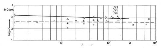
Fig. 21 Wie Fig. 20, aber für Polyurethanlackdrähte
