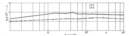
Fig.~18 Verlustwinkel tg  $\delta$  von Lackdrähten der Polyvinylacetalgruppe bei 1 kHz in Abhängigkeit von einer Langzeitlagerung in feuchter Atmosphäre
