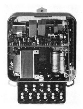
Fig. 1 Statischer Messumformer
