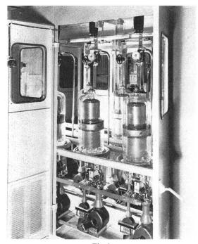
Fig. 3 Teil eines Gleichrichterschrankes mit sechs Hochleistungsthyratrons
