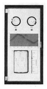
Elektronische Pumpenschutzund Steuerautomatik. Der neuentwickelte elektronische Pumpenschutz- und Steuerautomat ersetzt die bisherige Ausführung mit einem Spezial-Walzenschalter als Überwachungs- und Steuerorgan. Er erfüllt alle Aufgaben der bestehenden Ausführung und bietet dazu noch einige wichtige Neuerungen.
