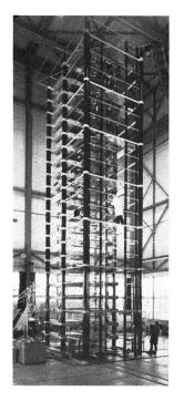
Fig. 1 Stoßspannungs-Prüfgenerator 4200 kV, 420 kJ bei der Prüfung im Werk
