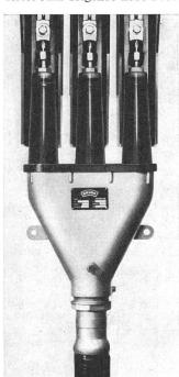
Das NDC-Kabel (Non-Draining-Compound-Kabel): Ein Haftmassekabel, das als Hochspannungs-Papierbleikabel (bis 20 kV) sich besonders zur Überwindung von Höhendifferenzen eignet. Ein weiterer Vorteil: Bei NDC-Kabelanlagen entfallen die periodischen Kontrollen der Endverschlüsse.
