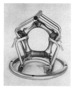
Fig. 1 Kabel-Einlenk- und Führungsrolle
