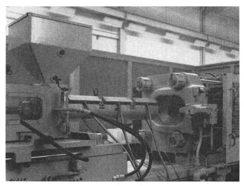
$Fig. \ 1$  Querverschiebung der Einpresseinheit für seitliches Anspritzen
