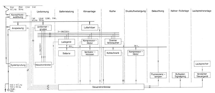
Fig. 2 Prinzipschema der gesamten Energieversorgung
