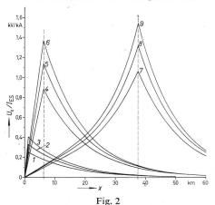
Spannung gegen Erde  $U_{\rm x}$  als Funktion des Abstandes x von der Mitte der beeinflussten Strecke, bezogen auf 1 kA Erdschlußstrom, für  $d=0,\ g=10^{-5}\ \Omega^{-1}{\rm m}^{-2}\ [r=10^5\ \Omega\ {\rm m}^2]$  und  $D=60\ {\rm cm}$
