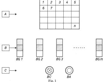
Principe de la disposition du pupitre de contrôle
