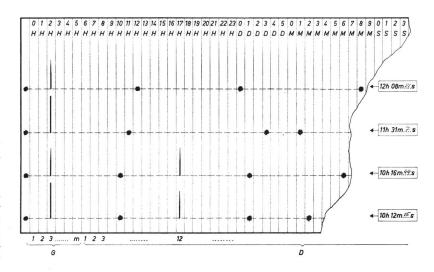
d) Enfin, quand l'opérateur effectue l'effacement de l'alarme de groupe, en fin de séquence, en appuyant pour la dernière fois sur le bouton combiné, le groupe en question se marque encore une fois sous forme d'une «comète».
