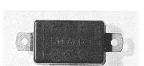
Im Transferpressverfahren ummantelte elektronische Komponenten
