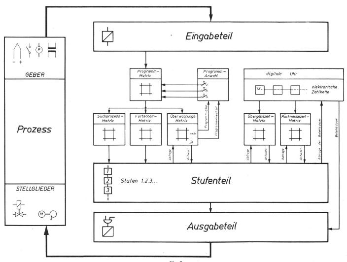
Fig. 7 Prinzipschema einer Folgesteuerung für die Prozessautomatisierung
