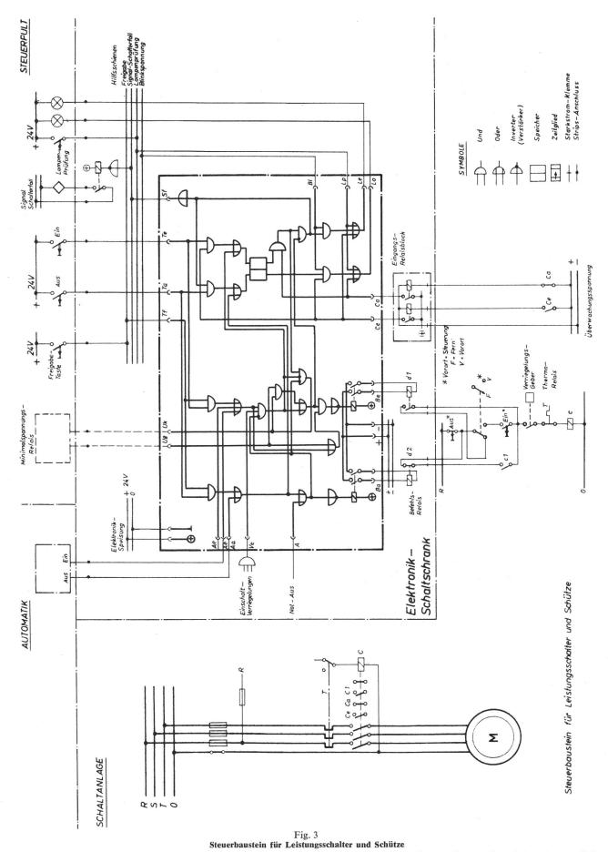
Das Schaltbild zeigt die interne Logik und die äusseren Verbindungen des Steuerelementes, einerseits zum Steuerpult und dem Automatik-Steuergerät und anderseits zur Schaltanlage. Dargestellt ist die Steuerung eines Motorschützes
