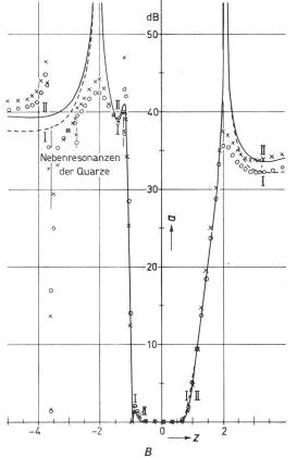
Fig. 12 Kompensation der Verluste durch Anderung des Übersetzungsverhältnisses A bei dem Einquarzfilter (Fig. 3a)
