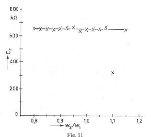
Der Parallelverlustwiderstand der filterseitigen Wicklungen (Windungszahlen  $w_1 = w_2$ ) als Funktion der ausgangsseitigen Windungszahl  $w_3$ , normiert auf  $w_1$
