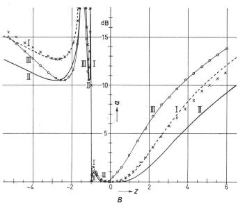
Fig. 13 Der Einfluss endlicher Übertragerinduktivitäten auf die Dämpfung des Einquarzfilters (Fig. 3a)
