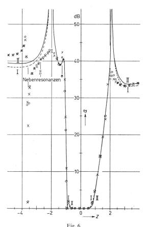
Dämpfungskurve eines Dreiquarzfilters gemäss Fig. 3b, welche durch Anderung der Kopplung nicht verbessert werden kann
