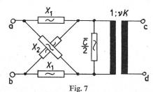
Ersatzschaltbild des Vierpols mit den Widerstandsparametern  $W_{1L}$ ,  $W_{2L}$  und M gemäss Gl. (25)...(27)
