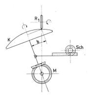
Kegel durch zwei getrennte, aber baulich und betrieblich gleiche Kugelkalotten ersetzt, damit sich die beiden Reibräder nicht gegenseitig behindern. Statt der dort auf dem Kegel seitlich verschiebbaren Reibräder  $R_1$  und  $R_2$  sind diese nun fest, und die Kugelkalotten werden ihrerseits entsprechend der Beschleunigung b bzw. der Geschwindigkeit v geschwenkt. Fig. 4 stellt das noch anschaulicher dar .
