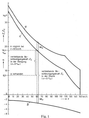
Leistungskurven einer elektrischen Schnellzuglokomotive der Baureihe E 10<sup>1</sup> der DB
