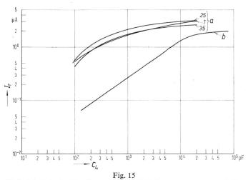
Abhängigkeit des breitbandig gemessenen TE-Störstromes  $I_{\rm p}$  von der Grösse der Koppelkapazität bei einer Sturzwicklung
