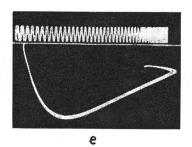
Fig. 1 Charakteristische Oszillogramme von Spannungsimpulsen, die den Schaltüberspannungen äquivalent sind a aperiodischer Impuls 50 | 5000  $\mu$ s; b schwingender Impuls f = 300 Hz; c schwingender Impuls f=800 Hz, Schwingungsdekrement  $\Delta=1.3$ , Zeitmarken 0,2 ms; d schwingender Impuls f=800 Hz, Schwingungsdekrement  $\Delta = 2.8$ , Zeitmarken 0,2 ms; e aperiodischer Impuls 2000 | 5000  $\mu$ s, Eichfrequenz  $f_e = 5 \text{ kHz}$
