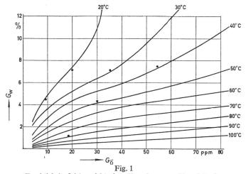
Feuchtigkeitsgleichgewicht eines Komplexes aus öl und Papier bei verschiedenen Temperaturen
