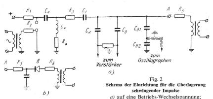
erfordern möglichst vollständige Kenntnisse über das Verhalten der Isolation bei allen Arten der Betriebsbeanspruchung. Die untersuchte Einwirkung von Schaltüberspannungen auf die Papier/Öl-Geräteisolation des Kondensatortyps wurde durch Impulsbeanspruchung nachgebildet. Die bei Schaltüberspannungen in elektrischen Übertragungsanlagen entstehenden Impulse haben die Form einer gedämpften Schwingung. Die Frequenz dieser Schwingungen liegt in der Regel im Bereich zwischen 50 Hz und einigen kHz.
