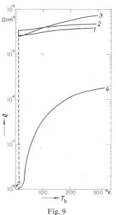
Spezifischer Widerstand von harten Supraleitern verglichen mit Kupfer Kurven: 1 Nb<sub>3</sub>Zr, nach Wärmebehandlung; 2 Nb<sub>3</sub>Zr, nach Kaltverformung; 3 Nb(22 at %)Ti; 4 Kupfer (Ultrarein); 5 OFHC-Kupfer
