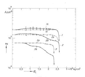
Fig. 6 Maximale Stromaufnahme von Nb(22 at %)Ti bei verschiedenen Feldstärken in Abhängigkeit vom Drahtzug
