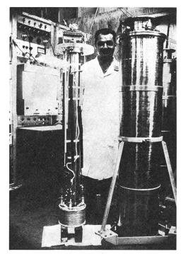
Fig. 2 Versuchsmagnet von 25 cm Innendurchmesser für 75 kGs
