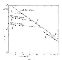
Fig. 4 Wärmeübergangswerte  $h\Delta T$ , gemessen im Spaltversuch
