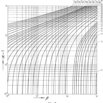
Fig. 7 Induktivitätsfaktoren  $L/a_1N^2=\lambda(\alpha,\,\beta)$  in Abhängigkeit von den Parametern  $\alpha$  und  $\beta$
